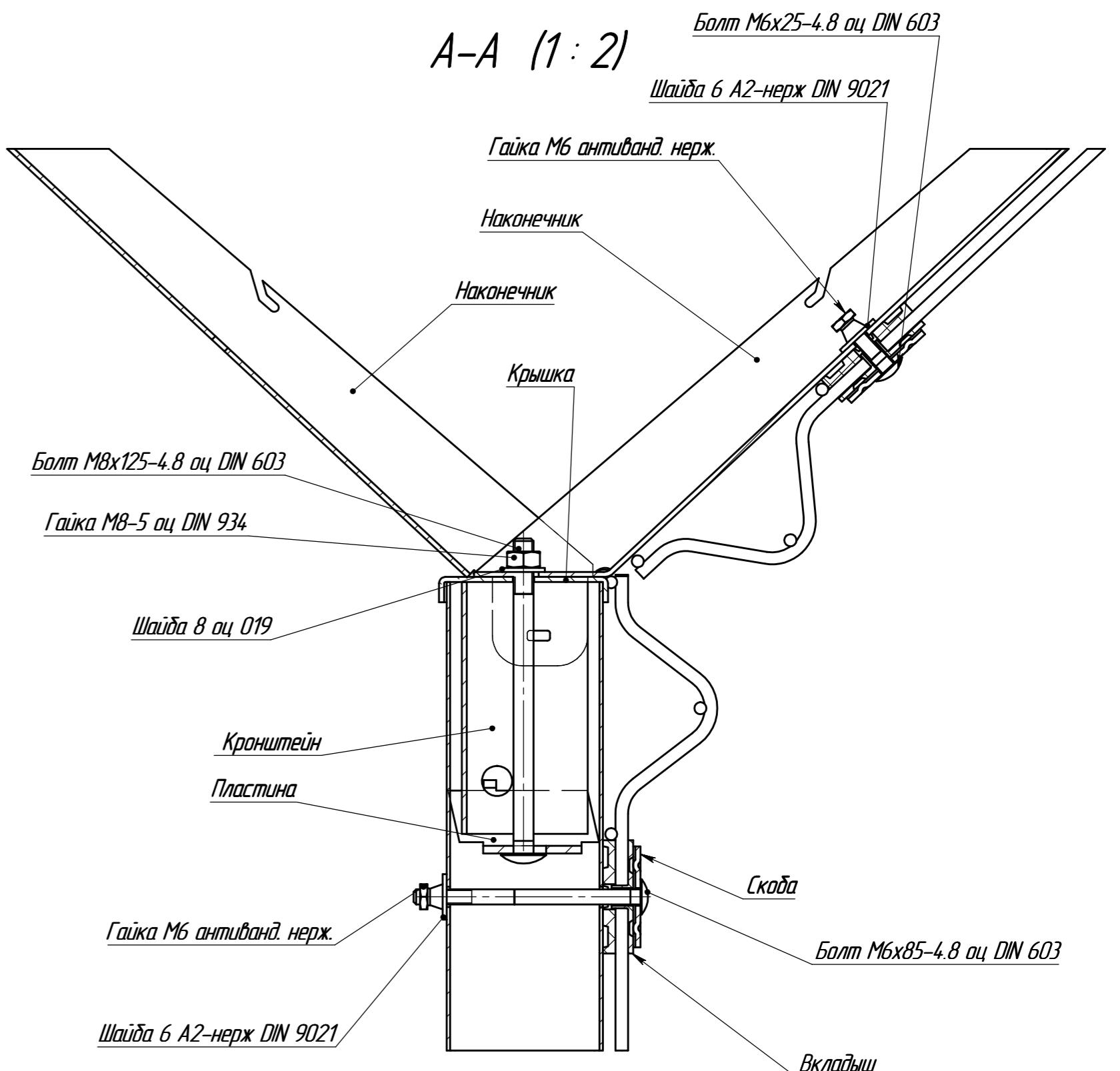
1. При монтаже панели (Панель PROFI высота 0,63 м) на наконечник вертикальную сетку перевернуть выступающими концами в сторону поверхности (см. рис.1)
